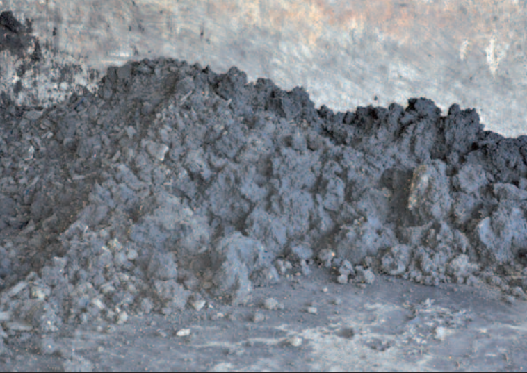
Klärschlamm bei Anlieferung
